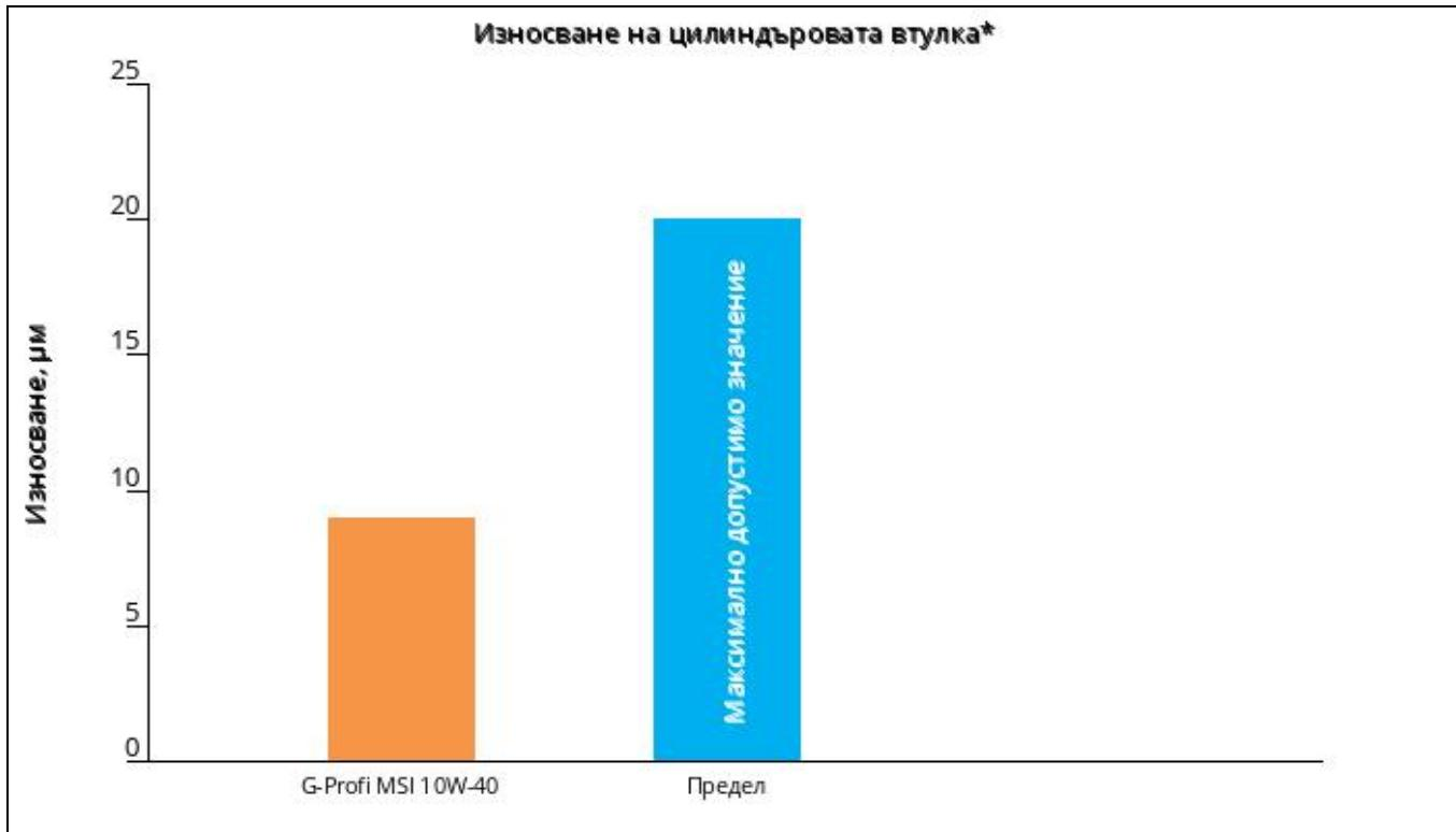
G-Profi MSI 10W-40 демонстрира висока защита срещу износване на повърхността на цилиндровата втулка, запазвайки живота на двигателя.
